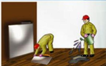
Все смотровые, технологические и другие люки и проемы в перекрытиях помещений, где проводятся огневые работы, должны быть закрыты негорючими материалами. Деревянные полы должны быть увлажнены.
