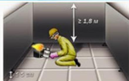
Место для проведения огневых работ в помещениях, в конструкциях которых использованы горючие материалы, должно быть ограждено сплошной перегородкой из негорючего материала.
