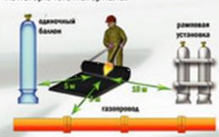
Место проведения огневых работ должно располагаться от трубопровода на расстоянии не менее 3 м, от одиночного баллона с газом – не менее 5 м, от рамповой установки – не менее 10 м.
